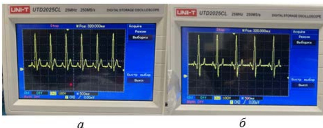
Рис. 3. Результат генерации аддитивной модели ЭКГ (а) и модели, полученной методом воспроизведения реального кардиоцикла
