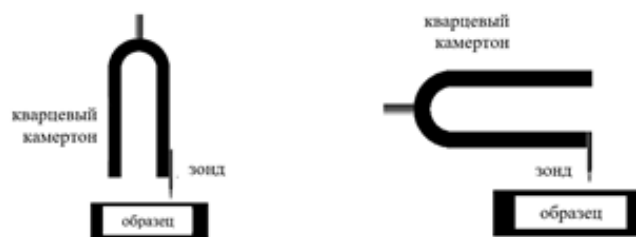
Рис. 1. Варианты монтажа капилляра на кварцевом камертоне
