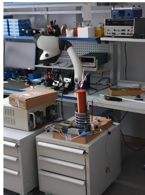
Рис. 5. Работающий трансформатор без внешнего корпуса
