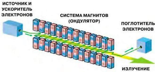
Рис. 1. Упрощённая схема ЛСЭ
