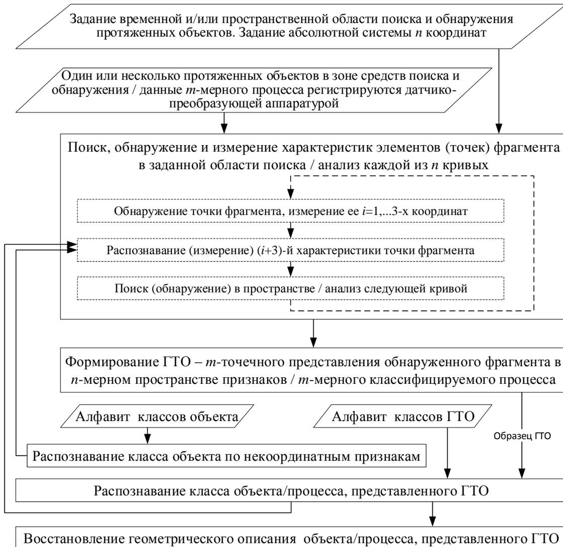
Рис. 2. Циклическая последовательность многоуровневых процессов распознавания на основе координатных и некоординатных признаков объектов и/или процессов
