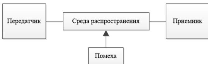
Рис. 1. Модель канала передачи информации
