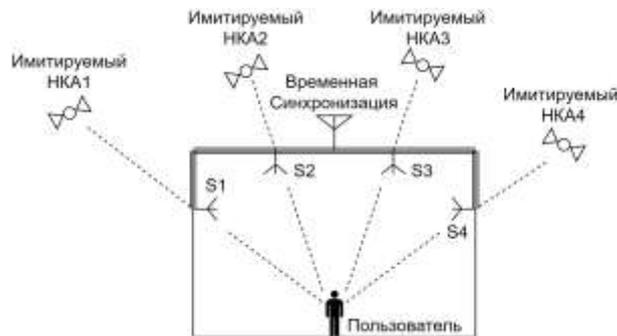
Рис. 1. Расположение основных объектов ЛНС относительно друг друга
