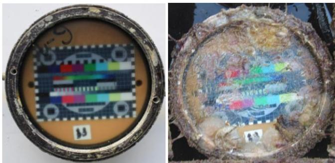
Рис. 1. Эпоксидно-изоцианатное покрытие с протатраном первый день погружения и 78 день после погружения
