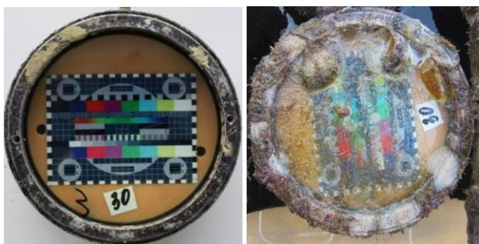
Рис. 2. Эпоксититанатное покрытие с мягким биоцидом – первый день погружения и 78 день после погружения
