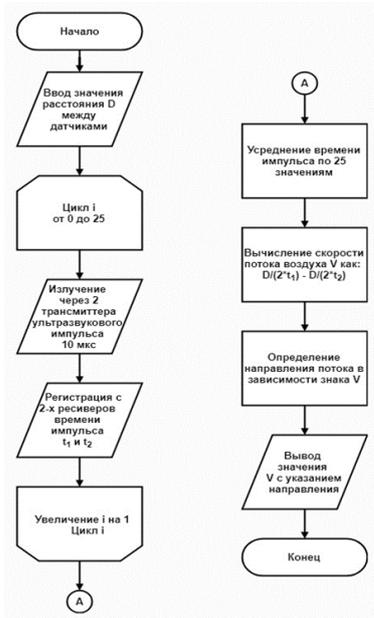
Рис. 2. Блок-схема устройства основанного на УЗ методе
