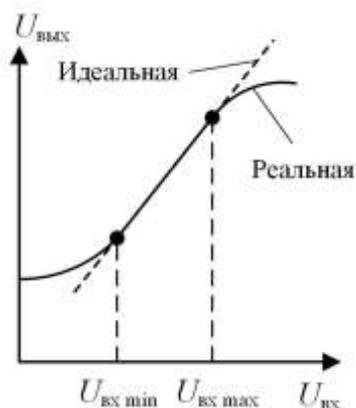
Рис. 1. Передаточная характеристика усилителя мощности
